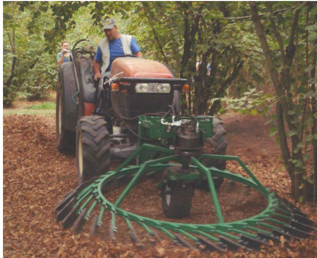
■ La cepilladora rotatoria hidráulica permite formar címulos o hilas de productos en suelo, facilitando la sucesiva cosecha por medio de máquinas arrastradas o automotrices. Está constituida por elementos rascadores en goma y se conecta al tractor. La cepilladora está alimentada por las tomas hidráulicas del tractor, dotada de pistón de levantamiento, motor hidráulico de rotación y regulador de revoluciones.
